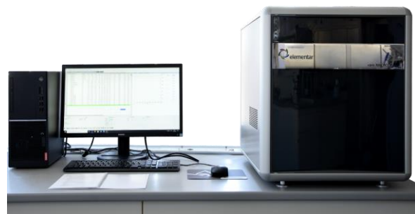
Quantitative Elementanalyse für C, H, N, S und O in organischen Verbindungen Quantitative Analyses for C, H, N, S, and O in Organic Compounds
